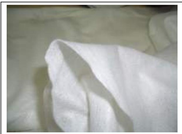
**GEOMAX** versterking. Een speciaal doek, gemaakt van synthetische vezels, speciaal ontwikkeld voor complementair gebruik met IMPERMAX lagen (en de elastische werking daarvan). Dit is ideaal voor situaties waar een extra beschermingslaag voor bescherming of versterking nodig is. Dit doek minimaliseert het zelfregulerende effect van het produkt en zorgt voor een toename in de uiteindelijk te verkrijgen dikte van de laag.
